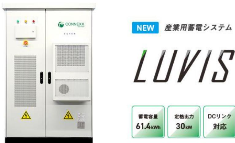
日常使いと非常時のベストバランスを追求した産業用蓄電池。蓄電容量 61.4kWh、定格出力 30kW で系統連系と自立運転を自動に切り替える機能を装備し、マイクログリッドにも最適。DCリンク対応モデル（年内発売予定）と ACリンク対応モデルをラインアップ。三相電源機器に対応し、大型エアコン・冷蔵庫・エレベーター、ポンプなどのバックアップに適しています。公共施設やオフィスビル、マンションのBCP対策、地域防災力強化に貢献する産業用／業務用の三相蓄電システムです。
